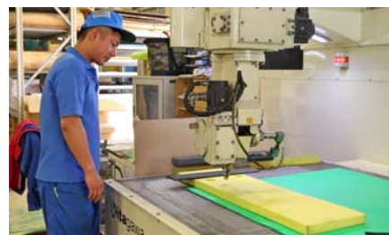
精密な切削加工を行う3Dウォータージェットカッター
