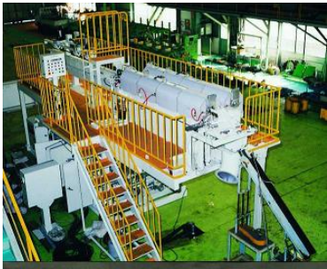
図1 誘導加熱装置
