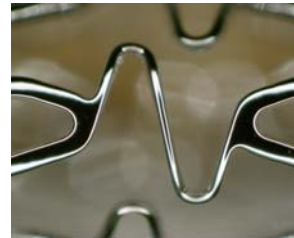
電解研磨により仕上げたステント
